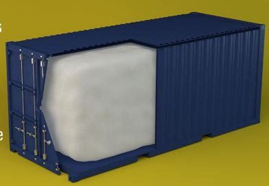
Les habillages intérieurs NITTEL pour conteneurs maritimes sont remplis soit par la porte via une goulotte soit par le dessus via une trappe. Ils sont équipés de cordes de guidage, d'un carton ondulé solide de protection de la porte, de barres de retenue en métal et de supports latéraux en carton ondulé pour une vidange du produit résiduel. Les habillages intérieurs NITTEL pour conteneurs sont adaptés à tous types de granules comme le PE ou le PVC.
